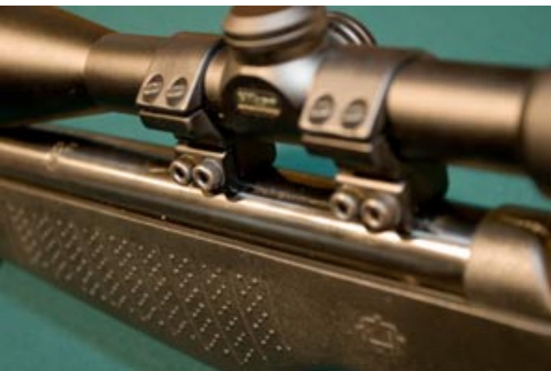
Stanowczo za krótka szyna montażowa celownika. O zamontowaniu dłuższych „lupek” można zapomnieć również ze względu na bardzo krótki cylinder i kostkę na końcu
