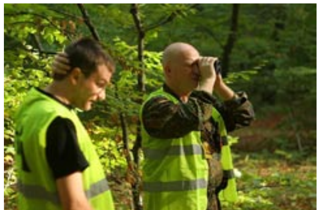
Technika powoli zastępuje tradycyjny „przymiar zwijany”. Tu dalmierz laserowy w akcji.
