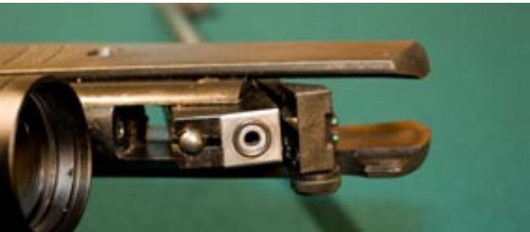
Port ładowania starannie obrobiony, szczęki trzymają kostkę pewnie. Niejako obawy wzbudza jedynie dość niepewnie działający zatrzask
